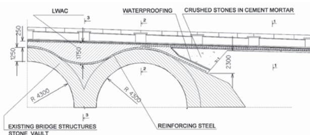
Fig 7. Longitudinal section
